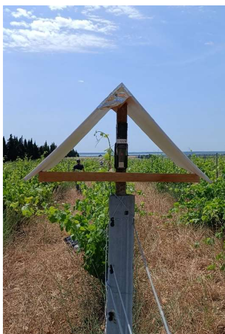
Figure 15 : Sonde VOLTcraft DL-121TH sous abris. Cette sonde permet de suivre en continue la température et l'humidité de l'air.
