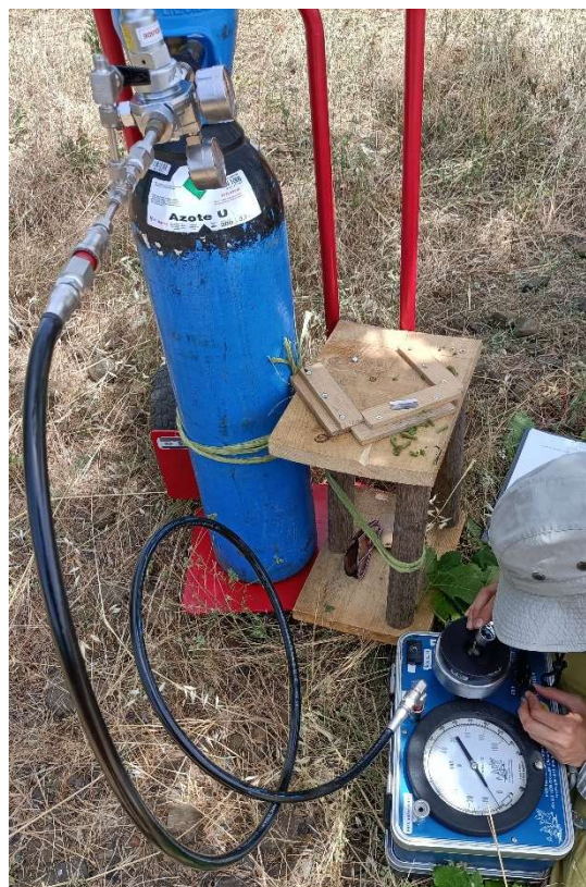
Figure 17 : Chambre à pression. Utilisation de la chambre à pression pour mesurer le potentiel hydrique foliaire (au midi solaire).
