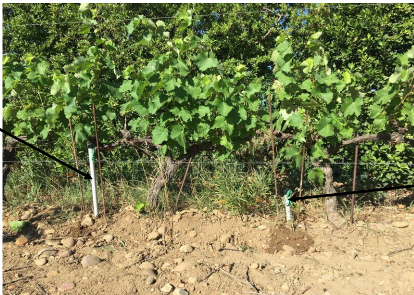
Figure 8: Sonde Watermark® de type tensiométrique installées sur le rang 1 de la parcelle des Peyrières (84)
